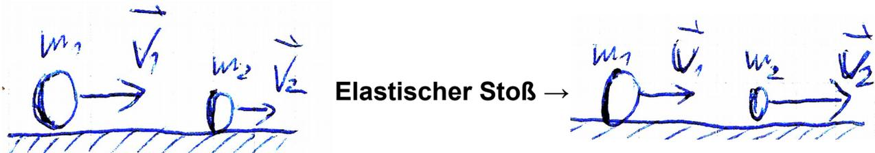
Gesucht wird eine Gleichung zur Berechnung von  $U_1$  bzw.  $U_2$  in Abhängigkeit von  $m_1, m_2, V_1, V_2$ .
